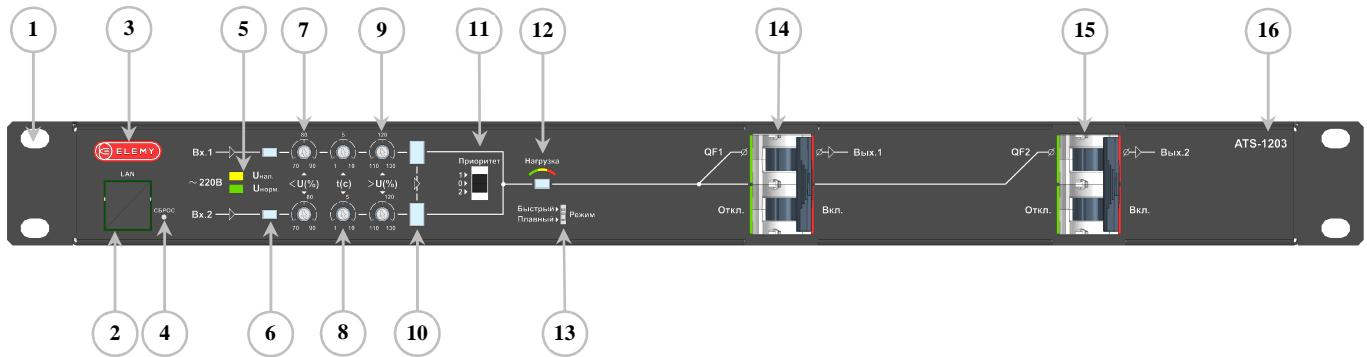
Рисунок 1 – Электронно-механический АВР ATS-1203, передняя панель:
